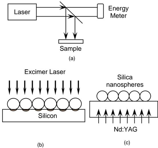
FIGURE 2. (A) SCHEMATIC OF THE EXPERIMENTAL SETUP, (B) IRRADIATION OF SILICA SPHERES ON SILICON FROM THE TOP SIDE, (C) IRRADIATION OF SILICA SPHERES ON GLASS FROM THE BOTTOM SIDE.
