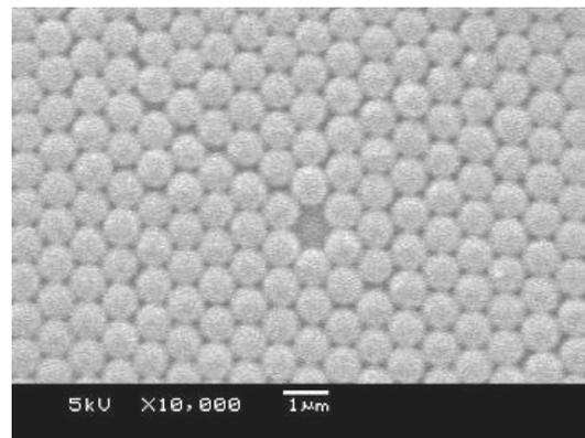
FIGURE 1. SEM MICROGRAPH OF THE HEXAGONALLY CLOSE-PACKED MONOLAYER OF SILICA NANOSPHERES.
